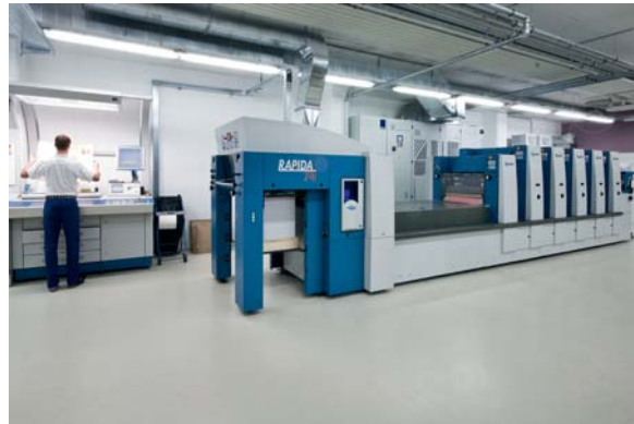
Die neue 5-Farb-Druckmaschine Rapida 74-5-L der Firma König & Bauer, Herzstück der Druckerei
