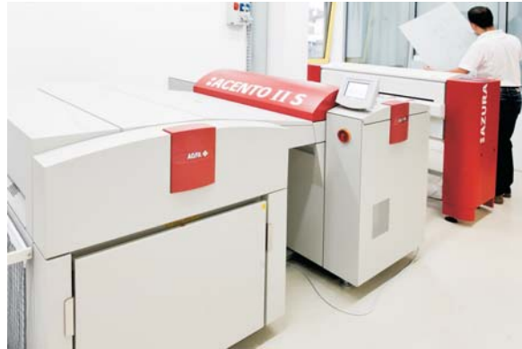
Der neue Computer to plate (CTP) zur chemiefreien Herstellung von Druckplatten
